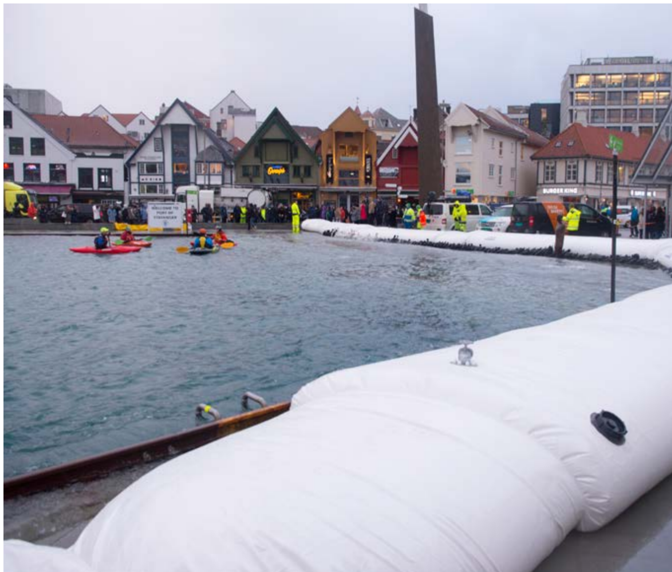
Stavanger sentrum 2017. Høy vannstand i Vågen som følge av stormflo i forbindelse med ekstremværet «Vidar». Stormfloen var på sitt høyeste 161 centimeter over sjøkartnull. Vannet steg litt over kaikanten, men ikke over de provisoriske barrikadene som ble utplassert.
